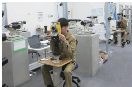
測量機器検定用コリメータ装置
